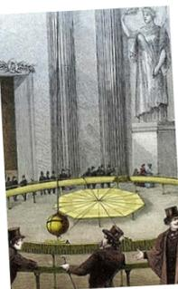
Pariser Panthéon ab: Der französische Physiker Léon Foucault bewies mit einem 67 Meter langen Pendel, an dem eine 28 Kilogramm schwere Kugel hing, dass **sich die Erde um die eigene Achse dreht**: Die träge Spitze zeichnete Spuren in den Sand.
